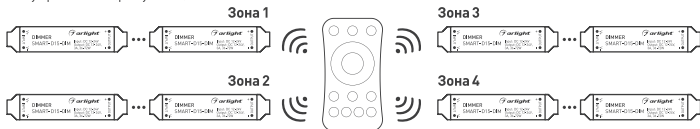
Рисунок 3. Вариант построения системы с 4-зонным пультом дистанционного управления.
